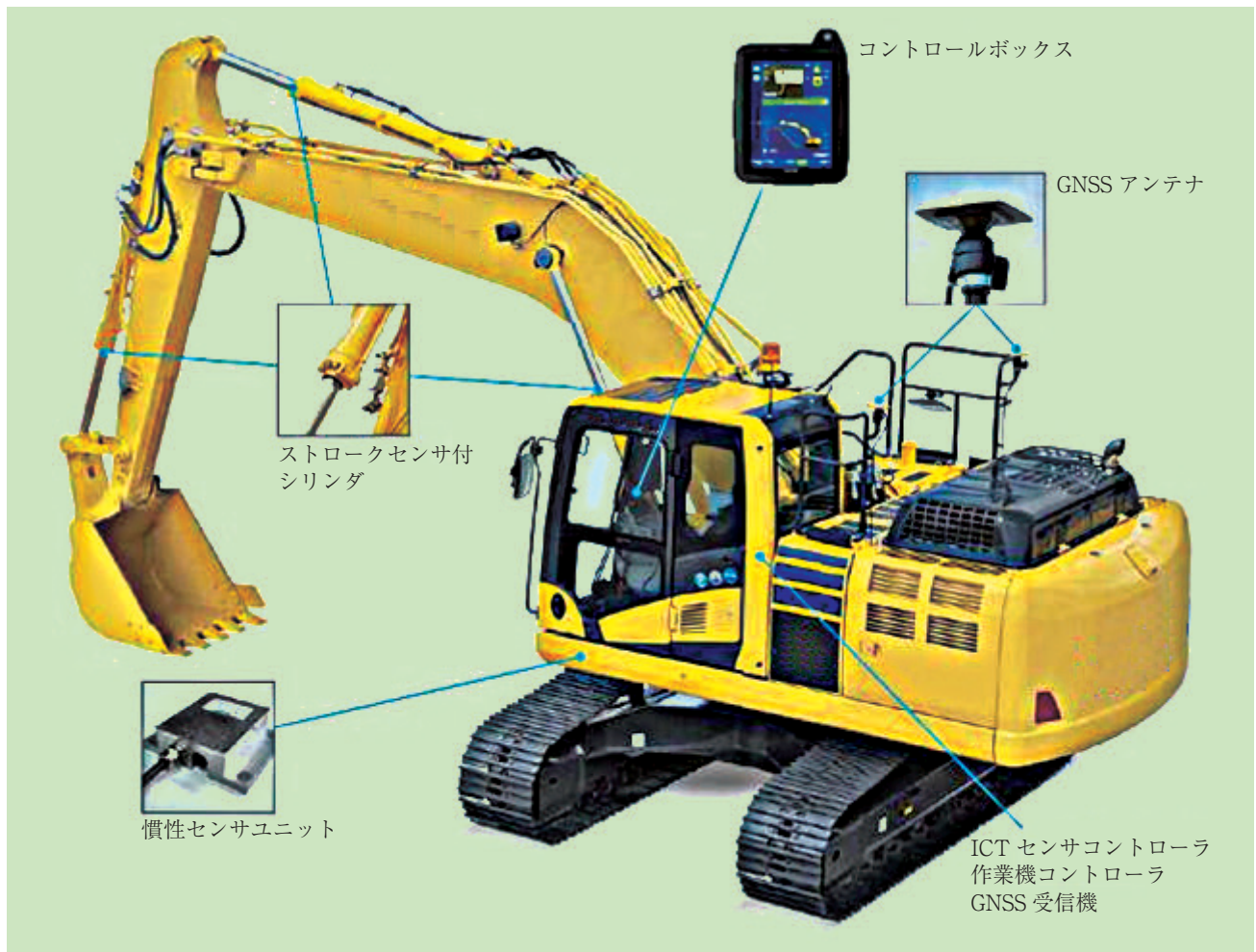
図3.6 3D-MC バックホウの機器構成例
